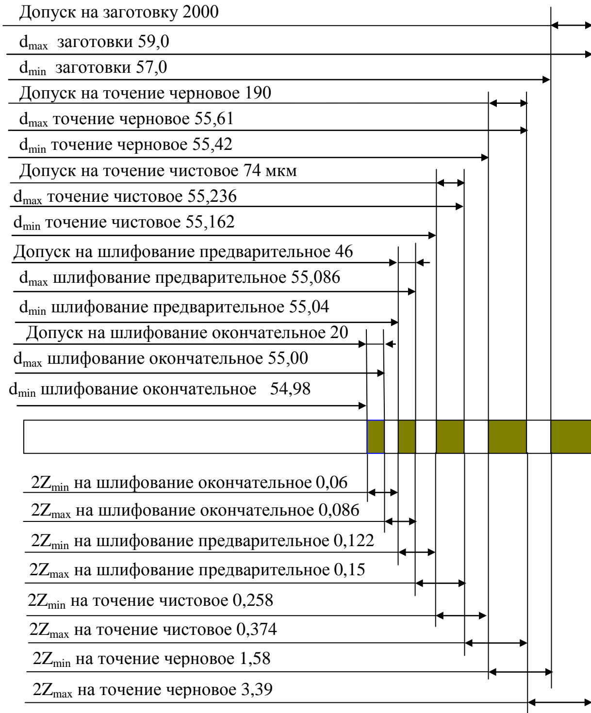
Рис. 3. Схема расположения припусков и допусков на обработку ступени \varnothing 55h6_{-0,02}
