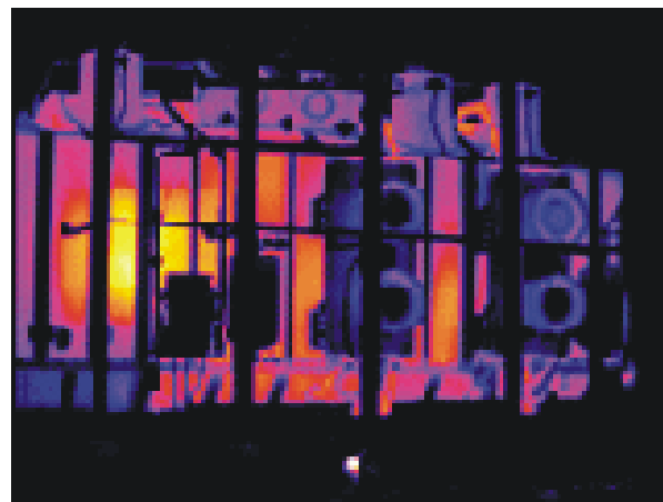
Перегрев электродвигателя системы охлаждения радиатора
