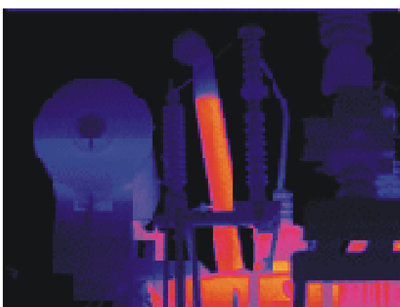
Локальный нагрев в баке (слева) со стороны 110 кВ
