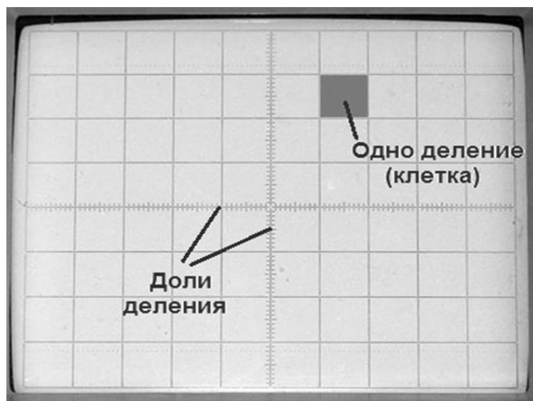
Рис. 8.4.6. Экран осциллографа
