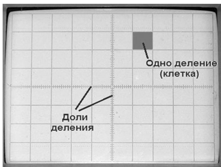
Рис. 9.4.6 – Экран осциллографа
