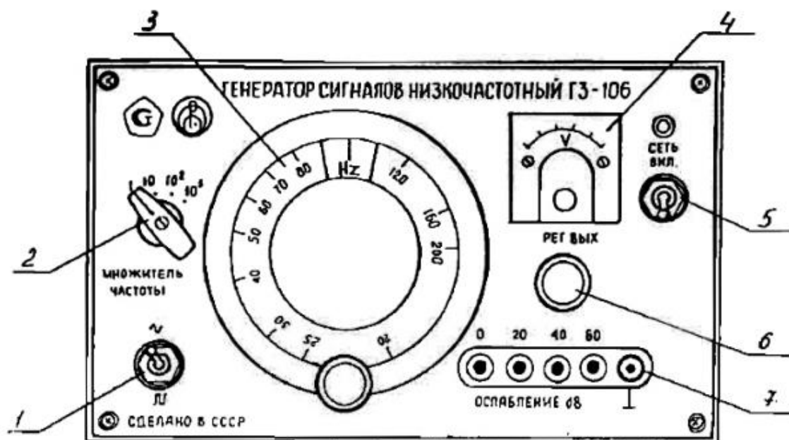
Рис. 1.3.6. Внешний вид передней панели генератора ГЗ–106
