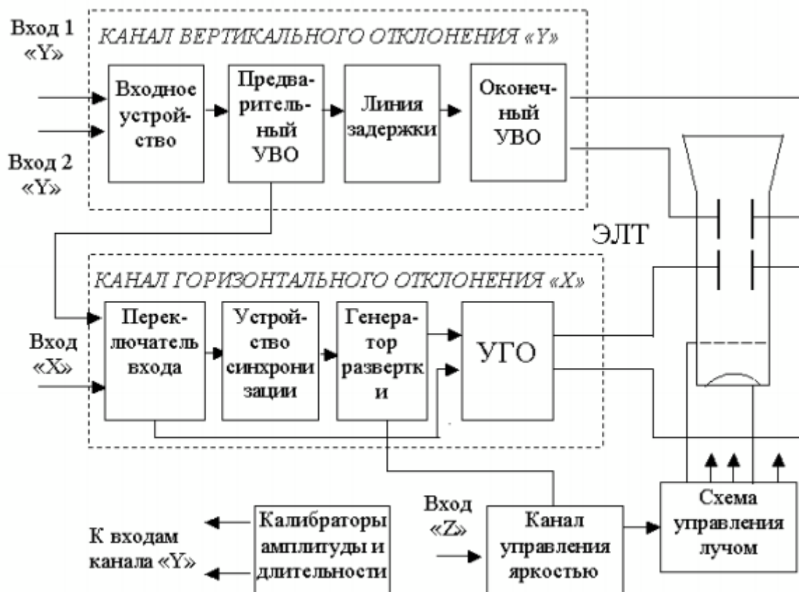
Рис. 7.2.1. Упрощенная структурная схема универсального осциллографа: ЭЛТ – электронно-лучевая трубка, УВО – усилитель вертикального отклонения, УГО – усилитель горизонтального отклонения.
