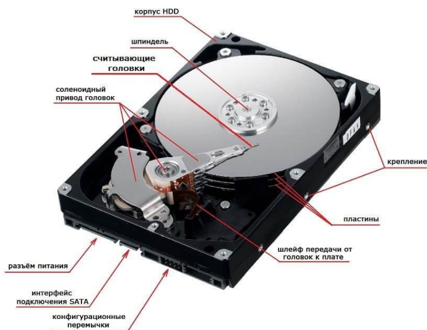
Рисунок 3 – Составные элементы HDD
