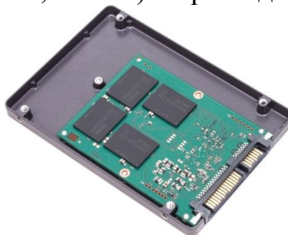
Рисунок 20 – Внутреннее строение SSD
