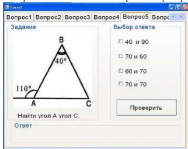
Рисунок 12.13 – Вкладки TabControl
