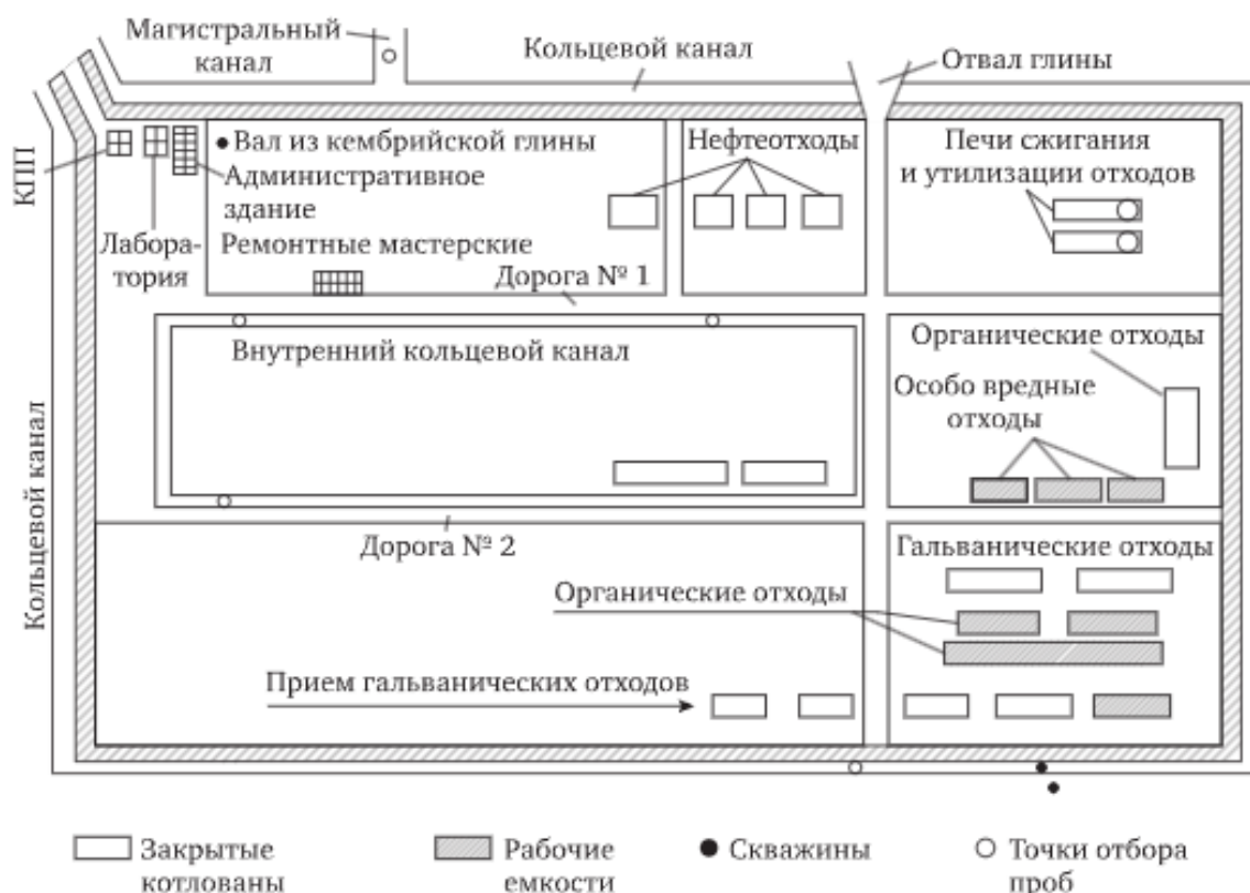
Рис. 2.1. Схема полигона «Красный Бор» для обработки и захоронения промышленных отходов
