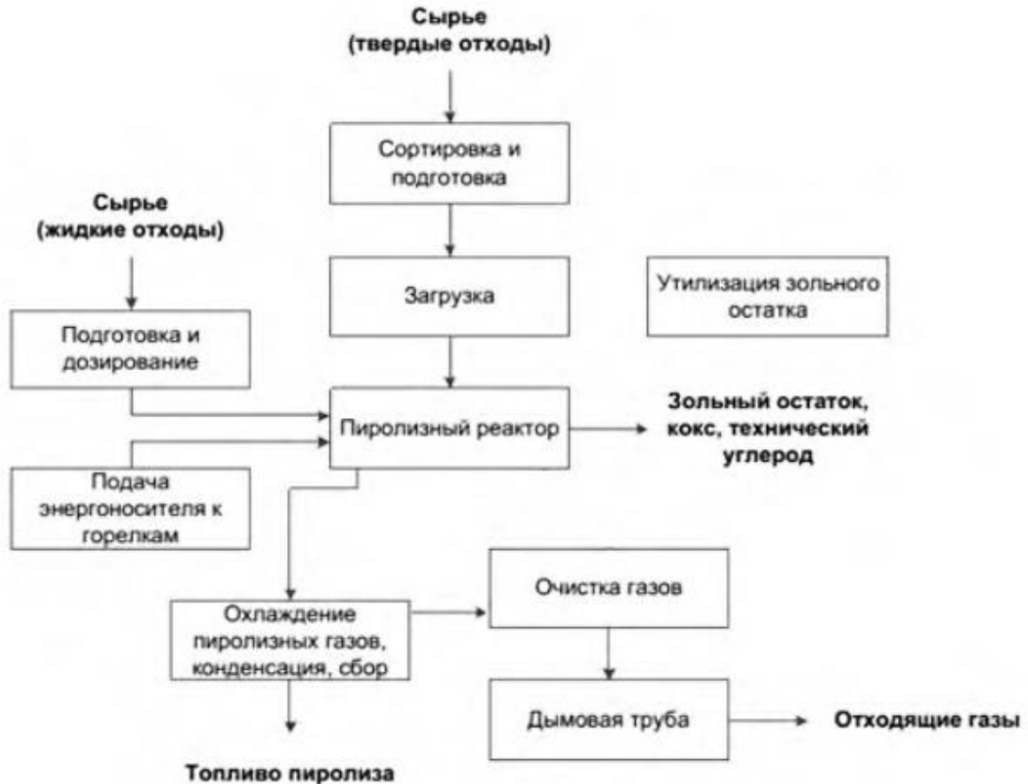
Рис. 2.6. Общая схема пиролиза отходов
