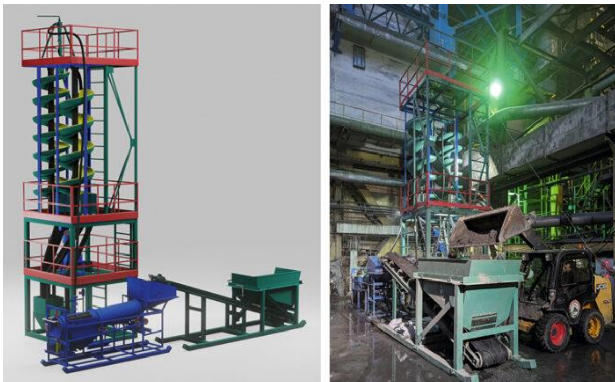
Рис. 2.10. Опытно-промышленная установка по переработке ЗШМ, установка работает на Кемеровской ГРЭС
