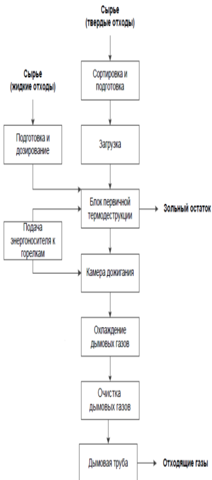
Рис. 2.5. Блок-схема сжигания отходов с целью обезвреживания и получения различных видов энергии
