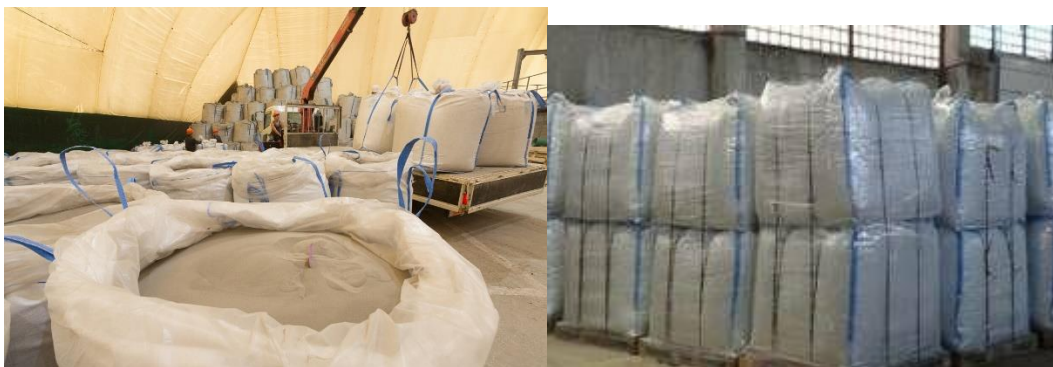
Рис. 1.7. Хранение и транспортирование золы в биг-бэгах
