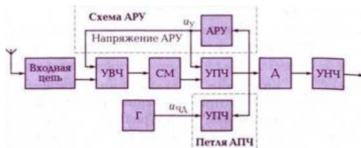
Рис. 32. Структурная схема супергетеродинного приемника с АРУ
