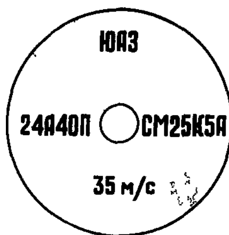
Рис. 5. Маркировка характеристики шлифовального круга
