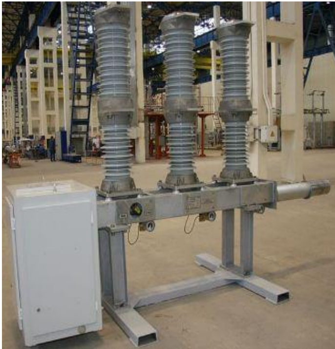
Рис. 10. Трехфазный колонковый элегазовый выключатель
