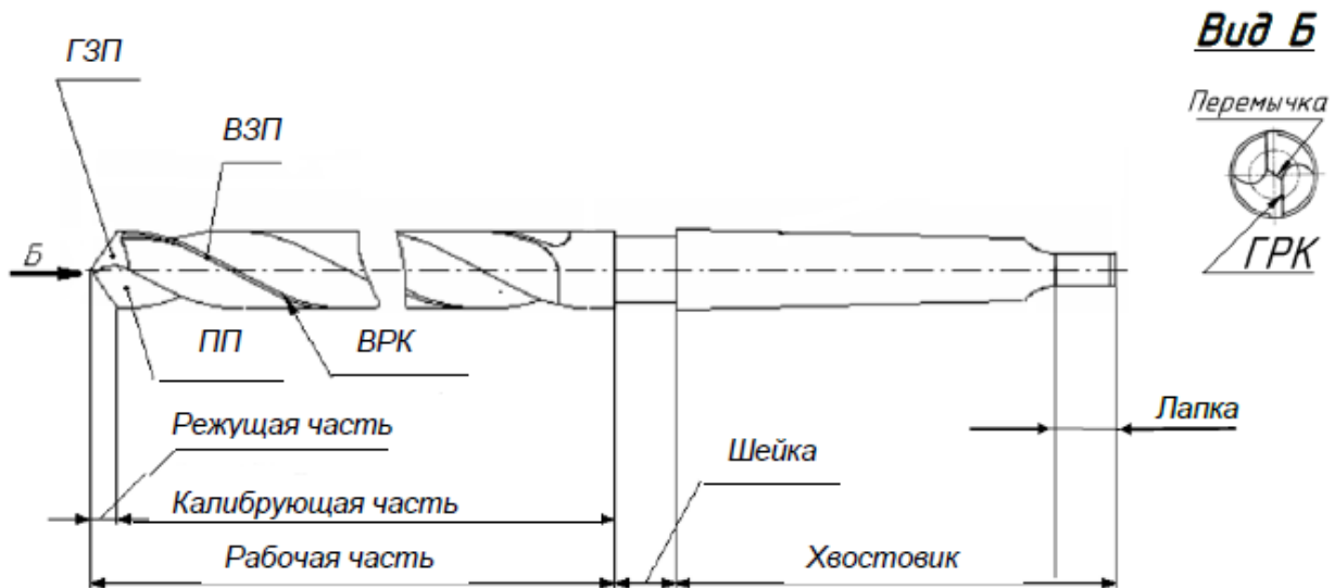
Рис. 1. Конструкция спирального сверла
