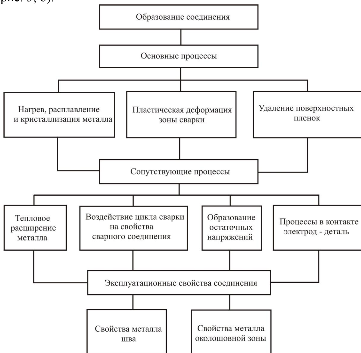
Рис. 2. Основные и сопутствующие процессы при образовании сварного соединения
