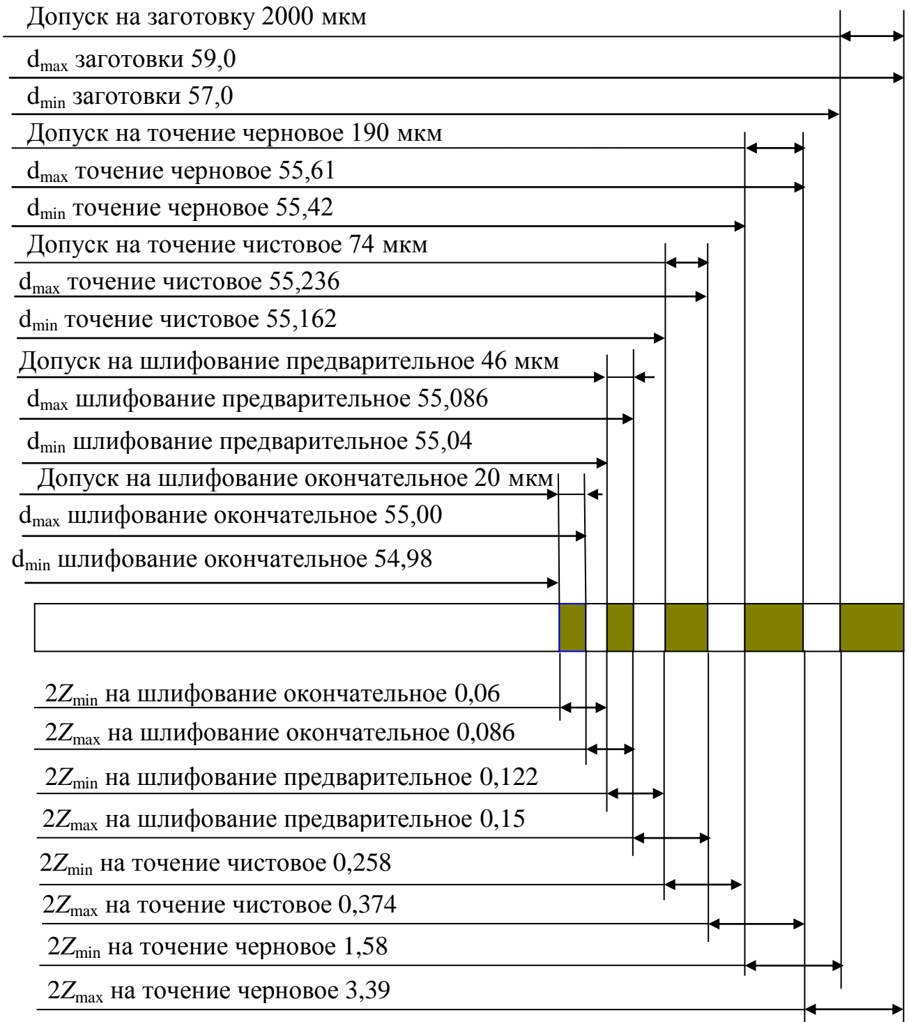
Рис. 3.3. Схема расположения припусков и допусков на обработку ступени \varnothing 55h6_{-0,02}
