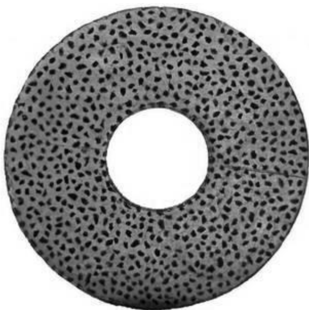
Рис. 1. Внешний вид модели отрезного шлифовального круга из оптически прозрачной связки и однорядным расположением зерен с размерами 100 \times 2,2 \times 32 мм
