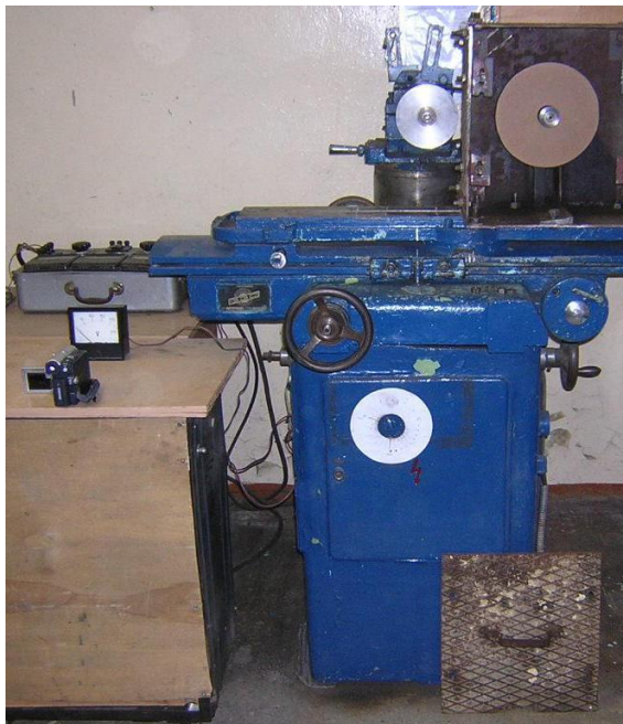
а) Рис. 1. Внешний вид (а) и конструкция (б) испытательного стенда
