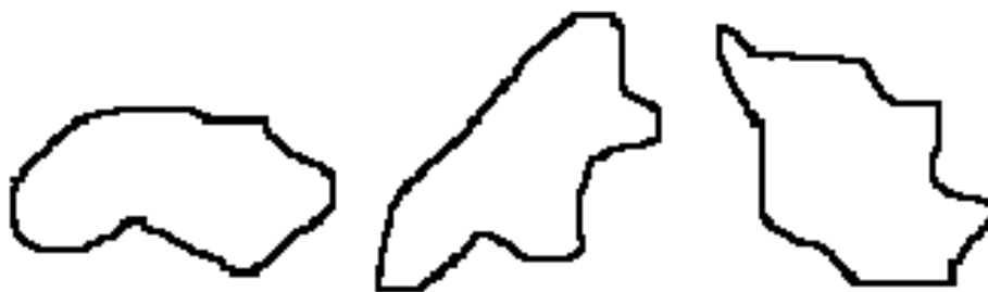
Рис. 4. Проекции зерен пластинчатой формы
