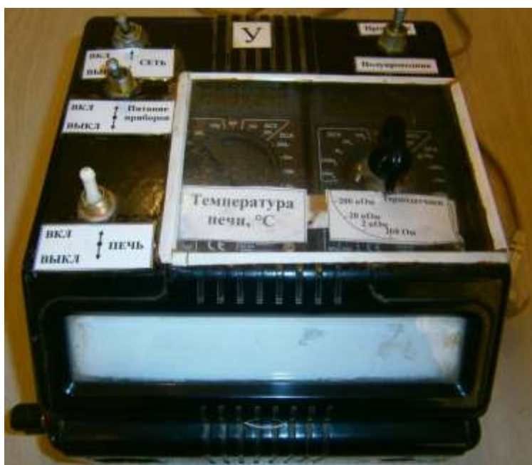
Рис. 1. Установка для изучения зависимости сопротивления металлов от температуры
