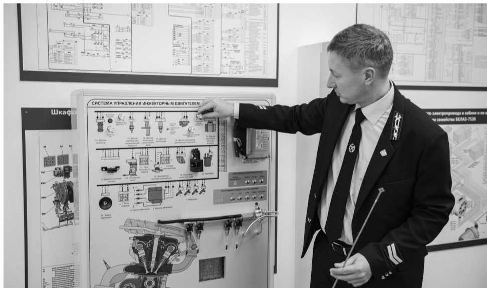
Для запуска системы достаточно вставить ключ в замок зажигания, как на реальном автомобиле, и увидеть работу системы впрыска.
