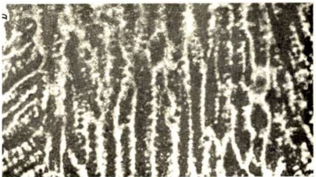
Рис. 2.6. Первичная структура металла шва из низкоуглеродистой стали \times 250
