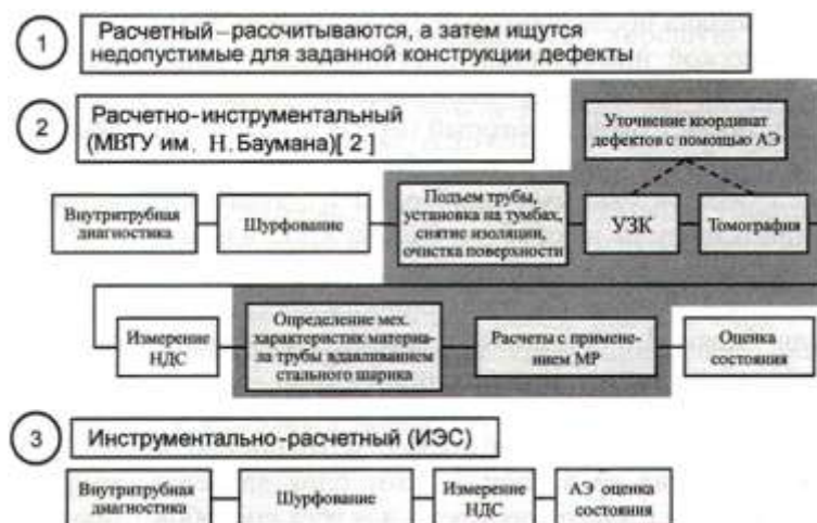
Рис.6. Методы оценки состояния конструкций на примере трубопроводов
