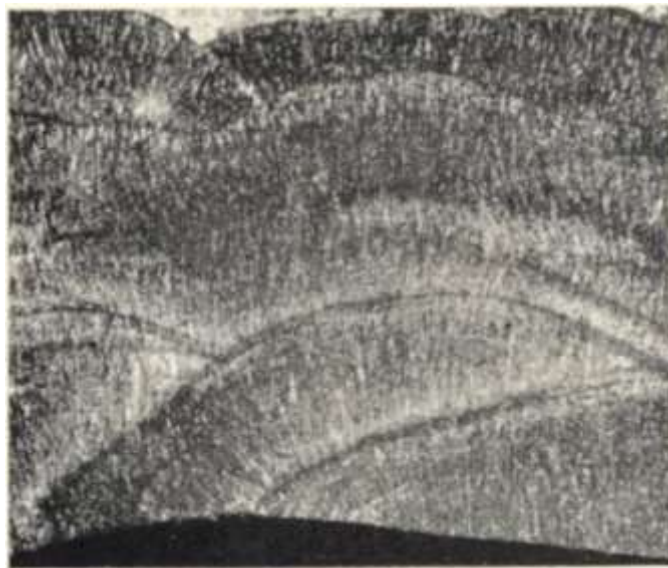
Рис. 2.10. Макроструктура многослойного сварного шва \times 20
