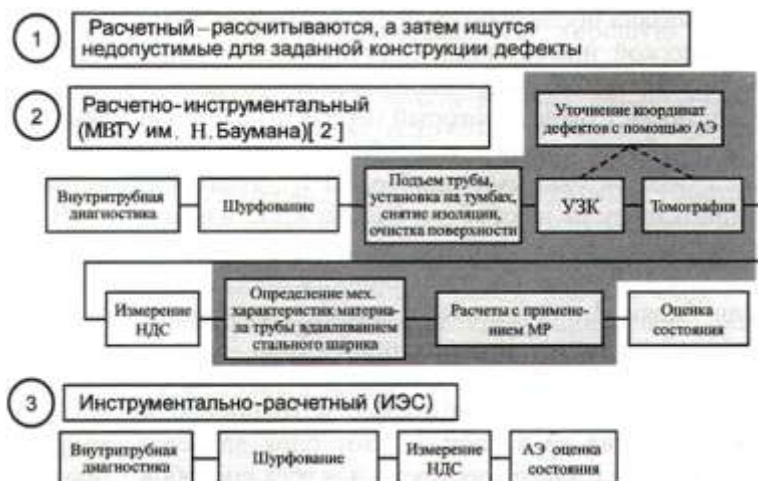
Рис.6. Методы оценки состояния конструкций на примере трубопроводов
