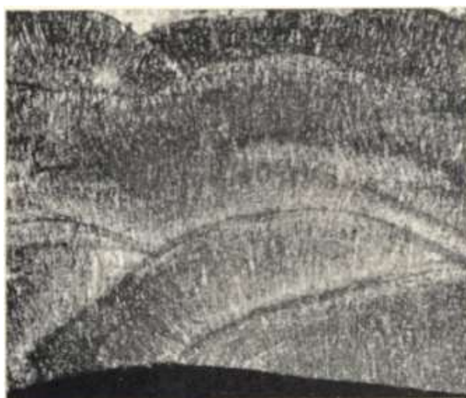
Рис.2.10 – Макроструктура многослойного сварного шва \times 20
