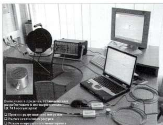
Рис. 4. Система АЭ диагностики ЕМА-ЗУ
