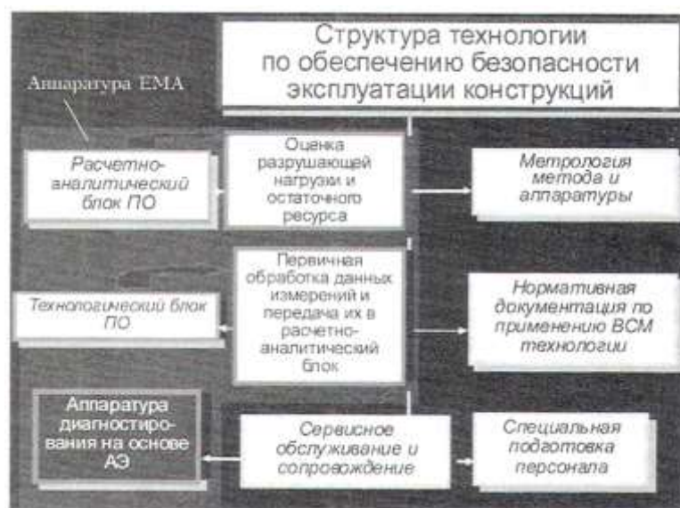
Рис. 1. Блок-схема технологии контроля на основе BSM
