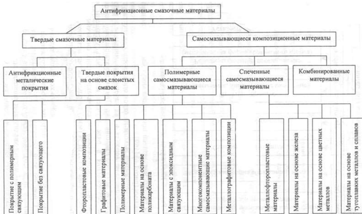
Рис. 7. Антифрикционные смазочные материалы и покрытия для узлов сухого трения
