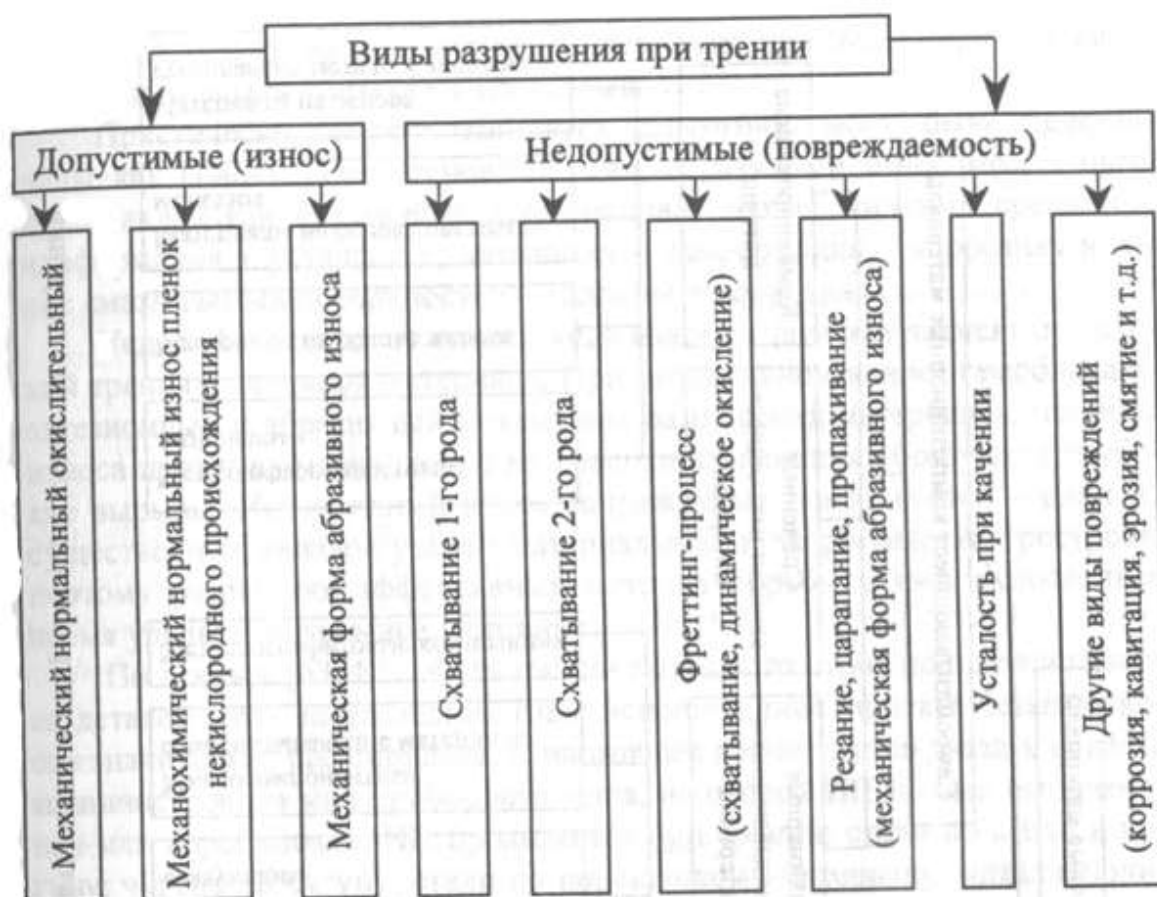
Рис. 6. Классификация видов разрушения при трении
