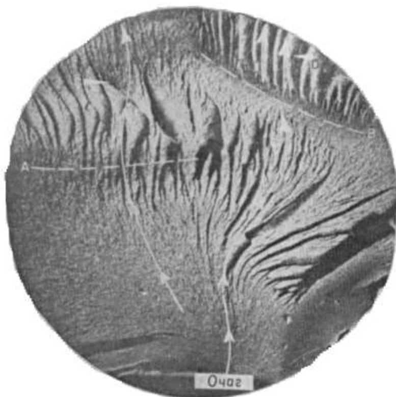
Рис. 9. Определение очага разрушения в изломе надрезанного прутка из стали с 12% Cr. Разрушение произошло в результате двух ударов молотка. Очаг разрушения может быть определен тремя способами: а) продолжением радиальных рубцов до их пересечения в нижней части излома (стрелки пакиривых указывают направление распространения трещины); б) построением нормалей к фронтам остановки трещины (отмечены А и В); в) проведением касательных к окончательным радиальным рубцам в С и D и проектированием их в направлении нижней части фрактограммы. Трещина остановилась на линиях А и В при первом ударе молотка и возобновила движение при втором ударе молотка. \times 3
