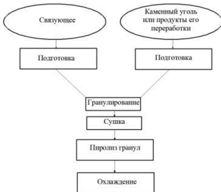
Рис. 1. Схема получения углеродного сорбента на основе каменных углей и продуктов их переработки
