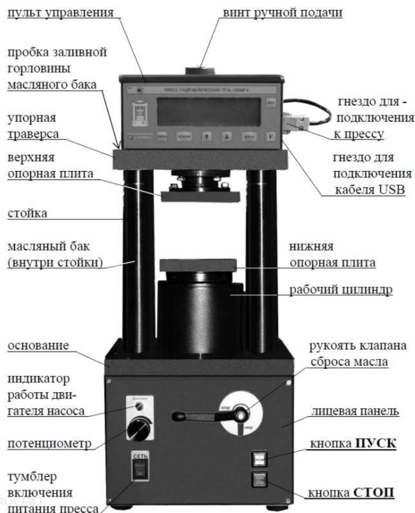
Рис. 8. Строение лабораторного пресса ПГМ-100МГ4
