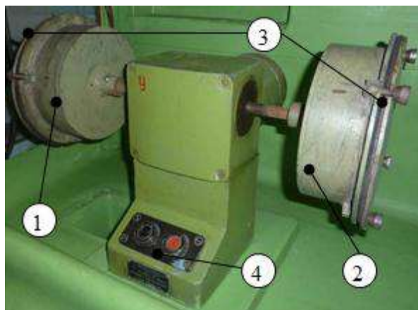
Рис. 8. Установка для определения прочности гранул на истирание: 1 – левый барабан; 2 – правый барабан; 3 – крышки для барабанов; 4 – панель управления
