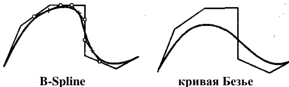
Рис. 2.21. B-Spline и кривая Безье, построенные по одинаковым дескрипторам
