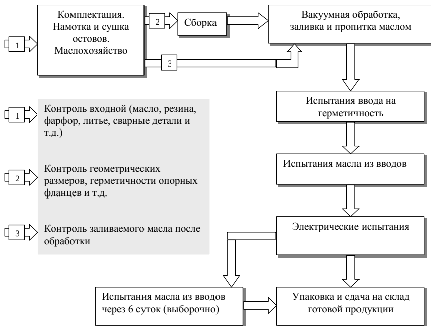
Рис. 2.1. Технологическая схема изготовления изоляции типа БМИ
