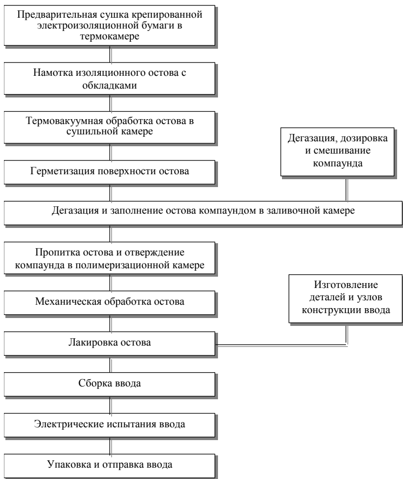
Рис. 2.2. Технологическая схема изготовления ввода с RIP-изоляцией
