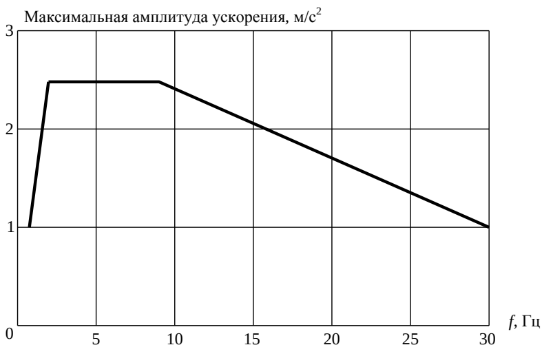
Рис. 3.5. Зависимость максимальной амплитуды ускорения от частоты вибрационного воздействия горизонтального направления
