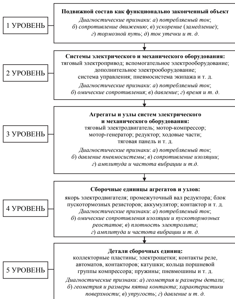
Рис. 4.2 Блочно-функциональная декомпозиция подвижного состава
