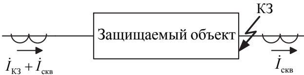
Рис. 7. Распределение токов в генераторе при внутреннем КЗ
