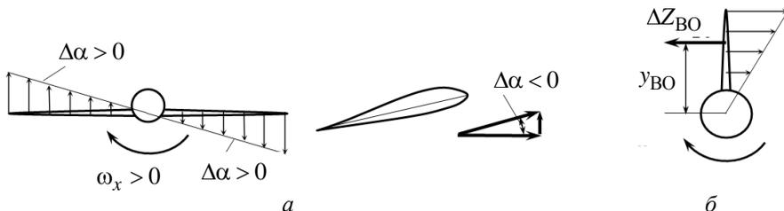
Рис. 2.26. Определение аэродинамических моментов крыла (а) и вертикального оперения (б) при вращении самолета вокруг оси  $Ox$
