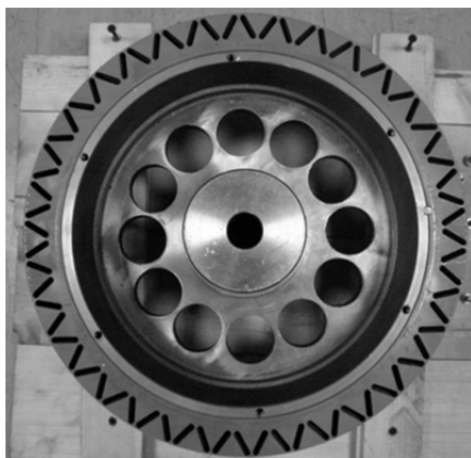
Рис. 2.14. Ротор с V-образной уста- новкой магнитов 34-полюсной ма- шины
