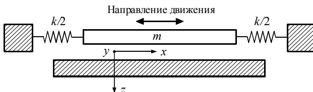
Рис. 3.13. Схематическое изображение модели демпфирования со скользящим слоем
