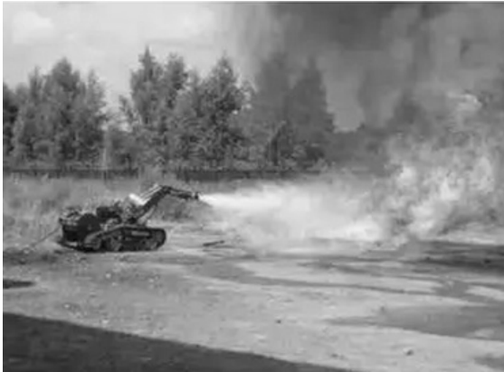
Рис. 8. Применение огнетушащих порошковых составов для тушения пожара разлития
