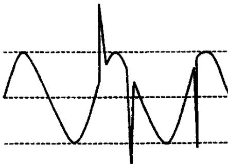
Рис. П3. Импульсные напряжения
