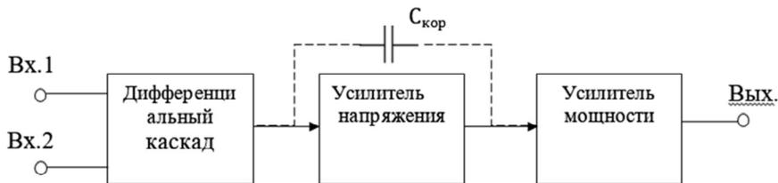
Рис. 3.6. Блок-схема ОУ
