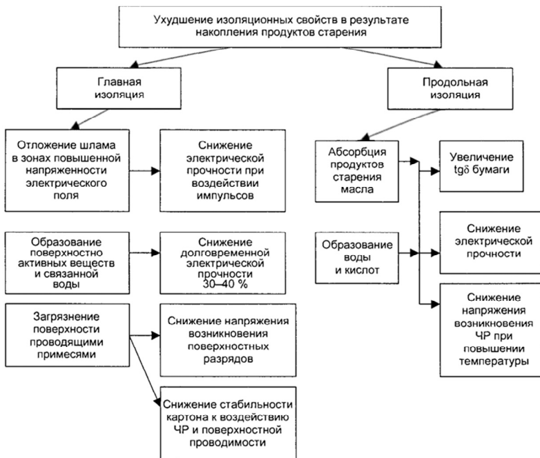
Рис. 3.1. Модель ухудшения изоляционных свойств главной и продольной изоляции обмоток
