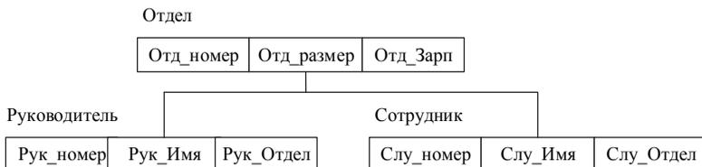
Рис. 1.6. Схема иерархической базы данных организации
