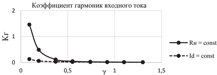
Рис. 10. Зависимость коэффициента гармоник входного тока преобразователя напряжения от уровня выходного напряжения
