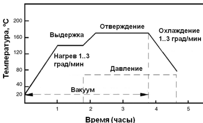
Рис. 19. Типовой цикл автоклавного формования изделия
