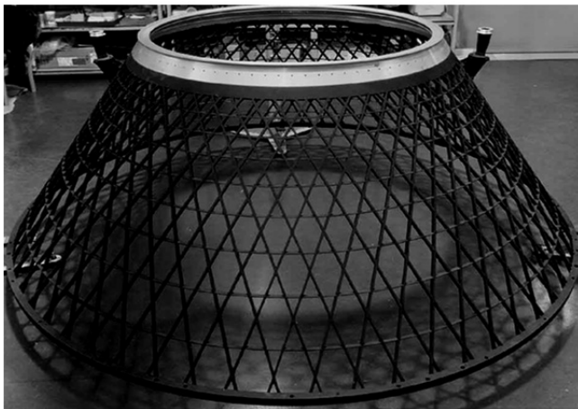
Рис. 26. Пример изделия, выполненного тетранамоткой
