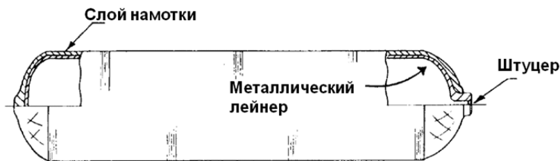
Рис. 23. Конструкция баллона высокого давления, изготовленного намоткой
