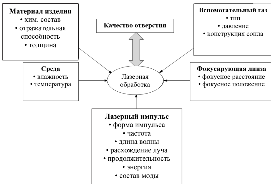
Рис. 4.3. Параметры, влияющие на качество отверстий, полученных лазером
