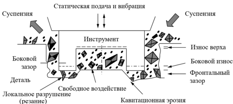
Рис. 1.4. Механизмы удаления материала при УЗО
