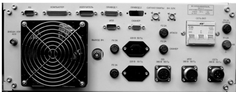
Рис. 4.12. Расположение элементов включения и разъемов на задней панели БКУ-2-2
