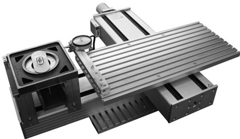
Рис. 4.9. Стол координатный X-Y 400×300. Выставка перпендикулярности по X-Y
