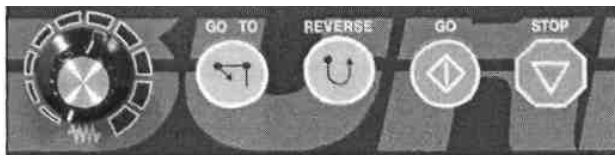
Рис. 6.17. Мембранные кнопки управления
