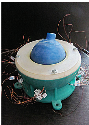
МКД с ротором типа А. Для прототипа было разработано новое программное обеспечение для перемещения вала ротора в точку, наиболее близкую к заданным координатам.
