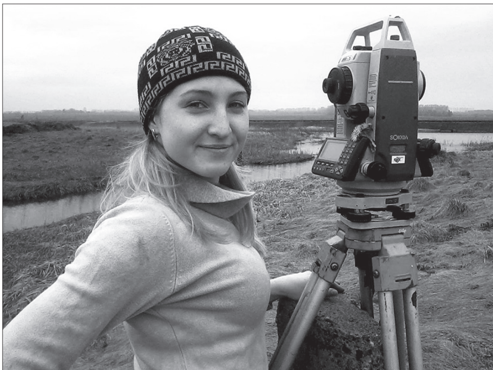
Екатерина Панфилова производит съемку отстойников, результаты которой позволят проследить за деформацией дамбы.
