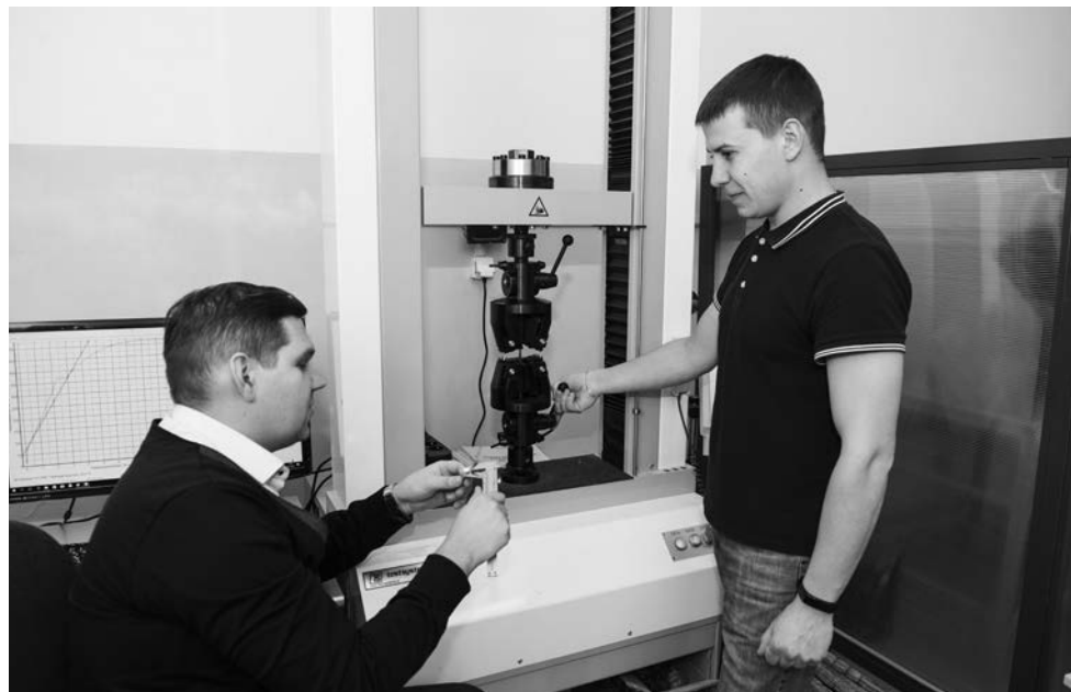
Магистрант Алексей Щепетков жажал металлический образец в разрывной машине. При растяжении на нем образуется шейка – место разрушения. Этому предшествует локализация деформации, которая не видна невооруженным глазом. Где именно проблемная зона, канд. техн. наук Николай Абабков будет определять методами неразрушающего контроля.
