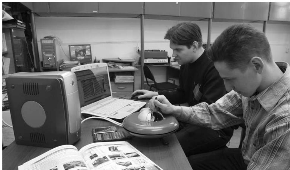
Специалисты кафедры технологии машиностроения Николай Абабков и Максим Пимонов проводят измерение профиля поверхности образца в наноразмерном диапазоне с помощью сканирующего туннельного микроскопа УМКА.
