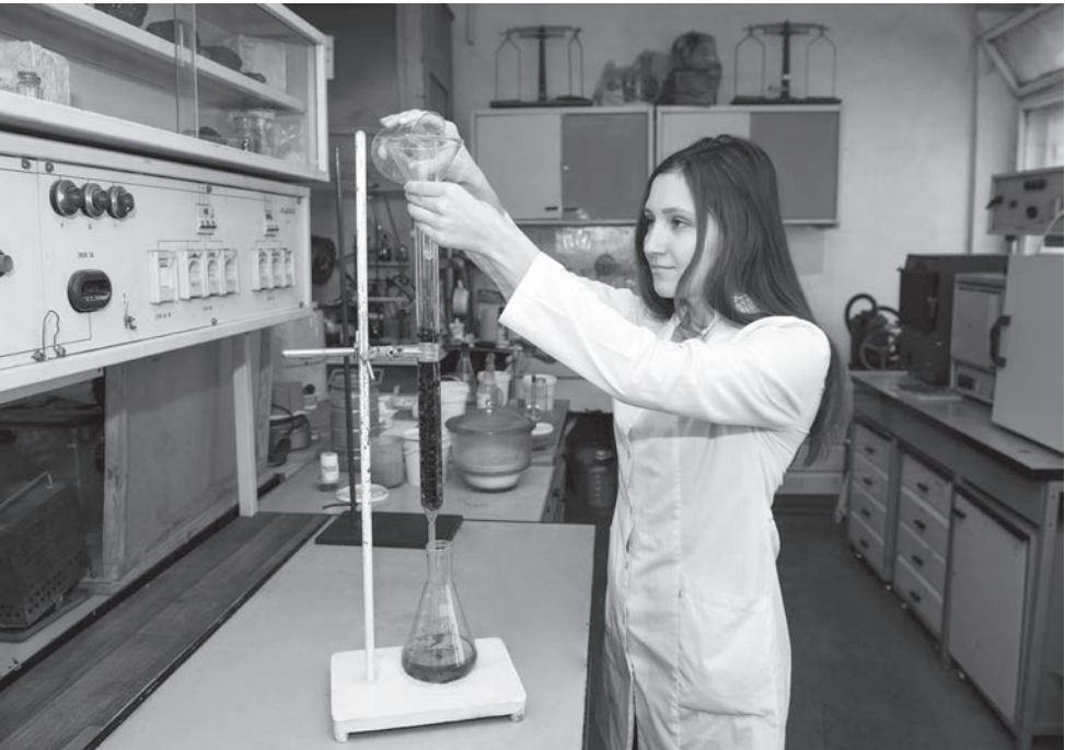
Для проверки нефтесорбента на прочность Лилия Соловьева использовала 50 литров воды. Вода вымывает частицы сорбента, оставляя самые прочные из них.
