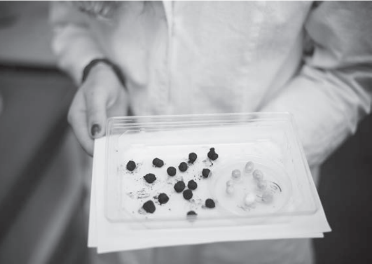
Оболочку нефтесорбентов изготавливают путем гранулирования отходов угольных, животноводческих и деревообрабатывающих предприятий, в том числе активного ила очистных сооружений.
