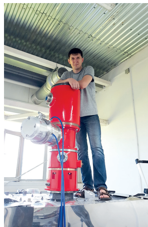
Технико-внедренческая зона (г. Томск). Электронно-лучевой ускоритель на 120 кВ
