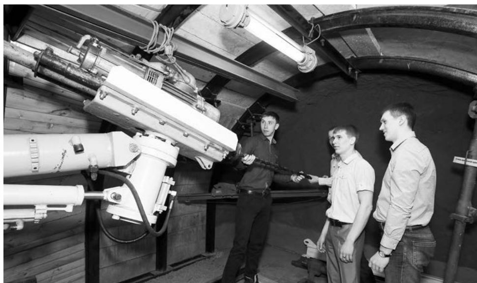
Практическое занятие в подземной лаборатории горного дела в филиале КузГТУ г. Прокопьевска. Студенты гр. ГПсд-141.2 изучают конструкцию подземной буровой установки.
