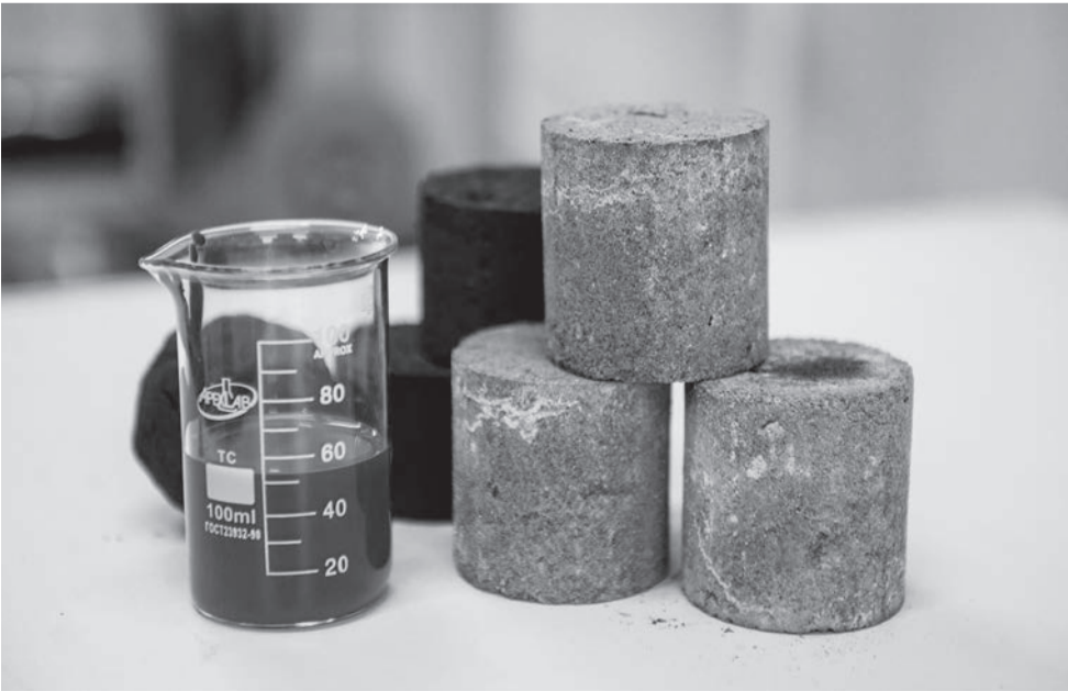
На переднем плане – брикеты из коксовой мелочи, шлама и пыли на основе связующего из золы уноса Кемеровской ГРЭС. В стеклянном мерном стакане – жидкое стекло из золы уноса Кемеровской ГРЭС. На заднем плане – брикеты из кека обогатительной фабрики.
