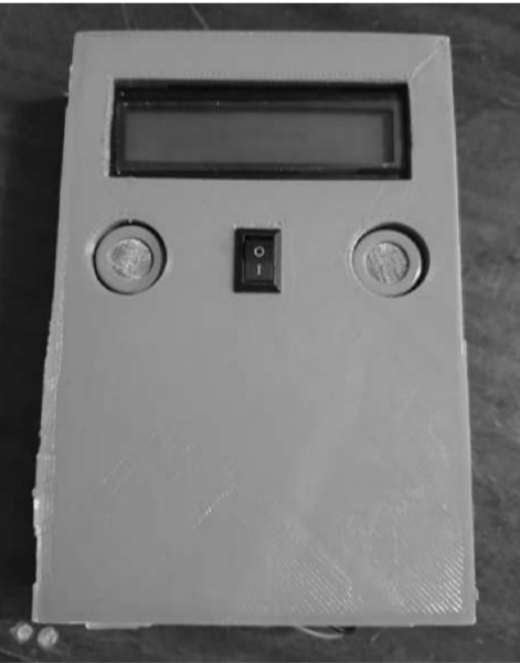
Для оценки загрязненности воздуха первокурсник ИПО Илья Гордополов разработал прибор на основе двух электрокаталитических датчиков оксида углерода.
