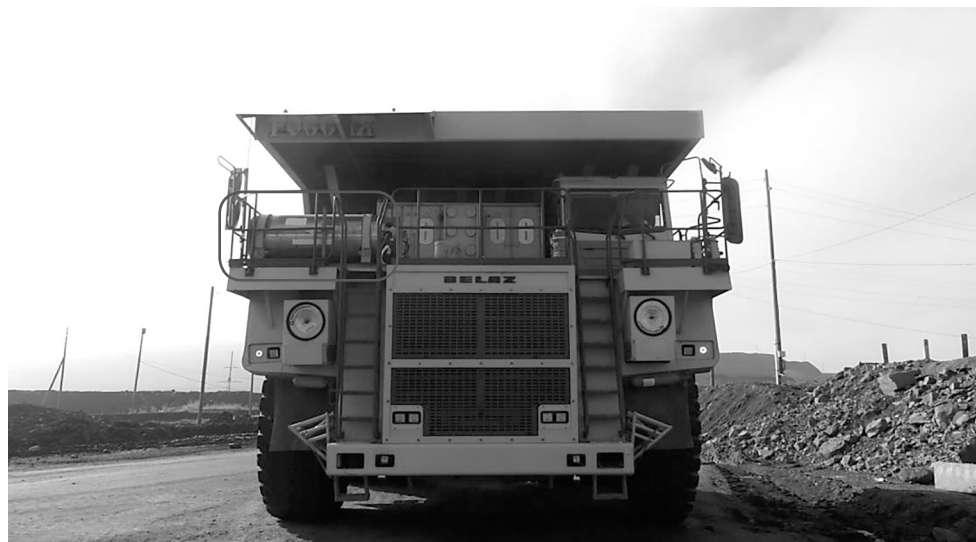
БелАЗ, оснащенный криогенной бортовой топливной системой.
