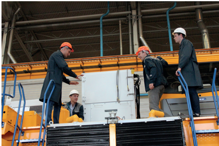
На палубе находится кабина водителя, основные узлы, агрегаты и электрическое «сердце» гиганта – шкаф управления электромеханической трансмиссией.
