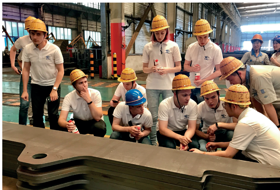
В центре внимания студентов КузГТУ – траверсы механизированной крепи. Они вырезаны высокоточным станком с числовым программным управлением, а робот обработал их контур газо-плазменным резком.
