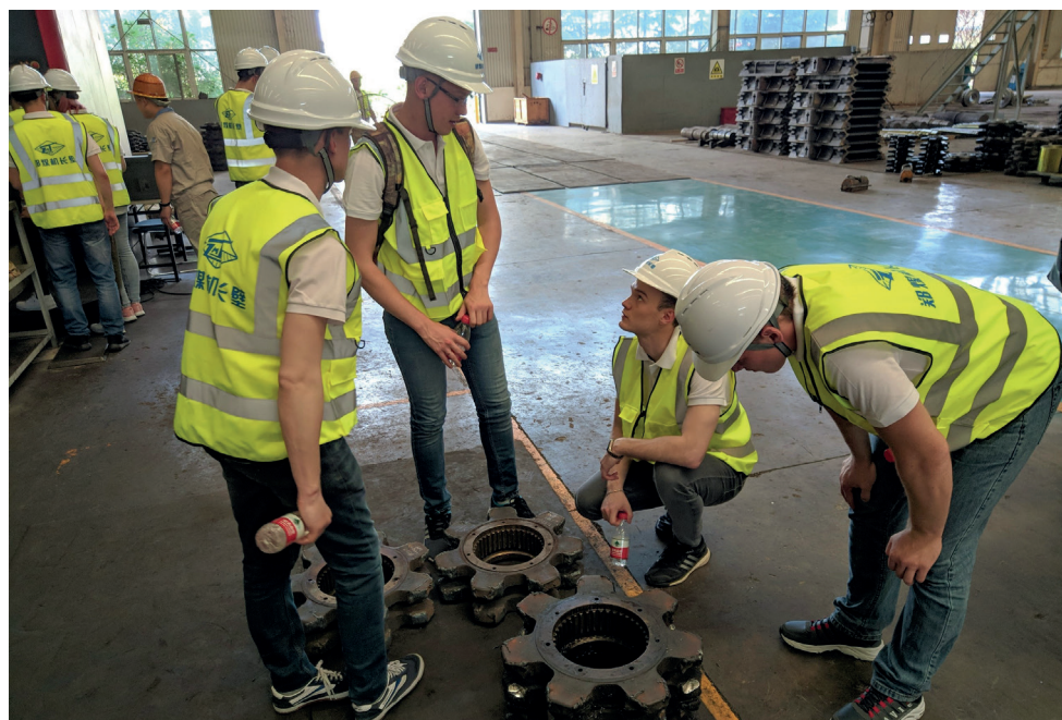
Качество обработки зубьев приводной звезды скребкового конвейера после ремонта на высоте! Оценено будущими инженерами из Кузбасса.
