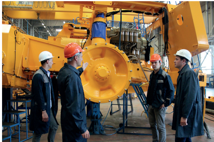
Практикантам Виталию Дунаеву, Никите Шерстобитову и Павлу Апарину рассказывают об установке на самосвале ступицы переднего колеса.
