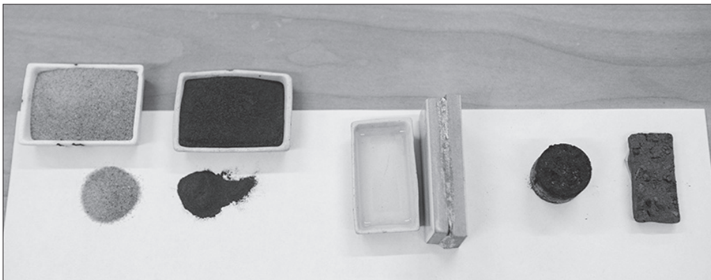
Ценные продукты линии переработки золошлаков (слева направо): микросферы, железосодержащий концентрат, жидкий клей, коксо-пылевые брикеты и фильтры для фильтрования отработанных трансформаторных масел.
