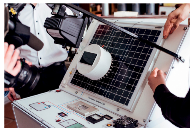
«Energy Tipster» – разработка студентов института энергетики, которая вызвала интерес партнеров из КНР. Робот по очистке солнечных панелей работает от аккумулятора и заряжается фотоэлементом на корпусе.
