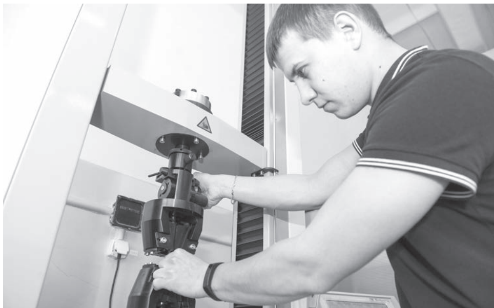
Магистрант Алексей Щепетков зажимает металлический образец в разрывной машине. В ней элемент растягивается от исходного состояния на 20-25 %.
