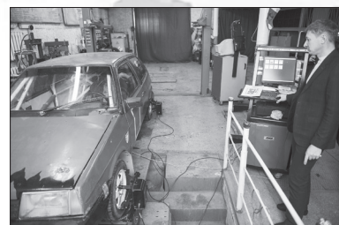
Диагностика «отклонений» управляемых колес.
